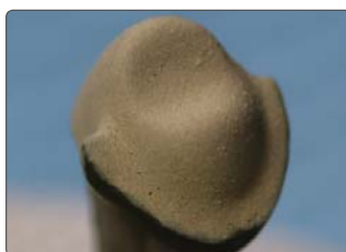
Вид коронки після спікання другого шару опаку
